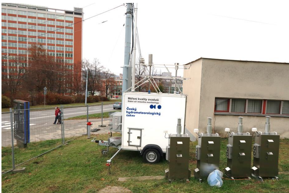
Obr. 21 Měření kvality ovzduší pro výpočet podílu silniční resuspence
